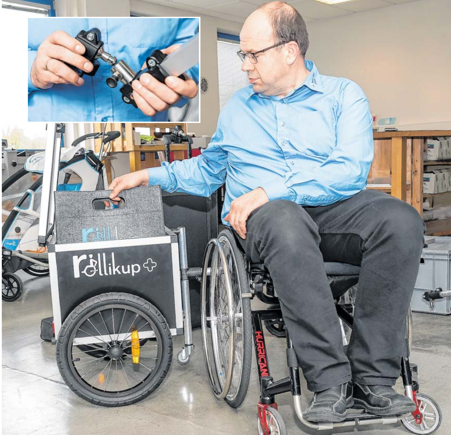
Erfinder: Eduard Wiebe hat sich in einen Rollstuhl gesetzt, um die Bedürfnisse behinderter Menschen nachvollziehen zu können. Auch einen Anhänger für Rollstühle mit passenden Taschen hat er konstruiert. Kleines Bild: Die Kupplung wird von der Werkhaus gGmbH angefertigt und lässt sich mit einer Hand bedienen. FOTO: JÖRG DIECKMANN
